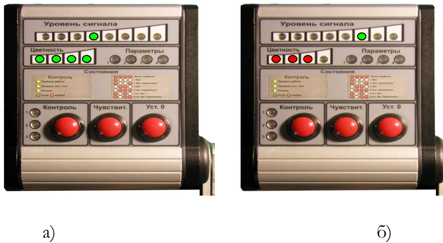
Рис.2.4. Индикация цветности объекта а) цветной металл б) черный металл
